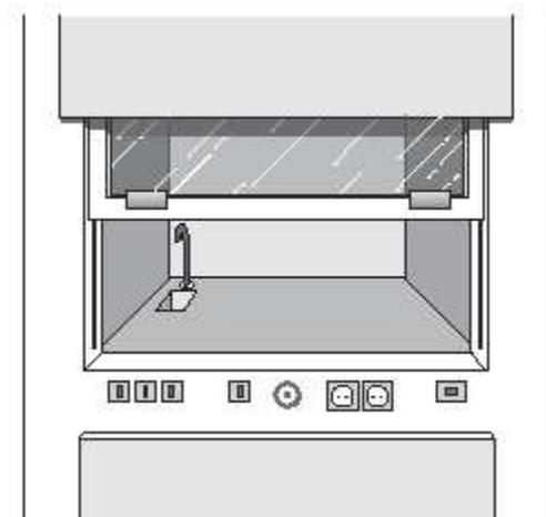
Las vitrinas de gases de laboratorio son equipos de protección colectiva para el control de la exposición ambiental a contaminantes químicos en el laboratorio.
