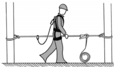
b) Línea de anclaje provisional de cinta
