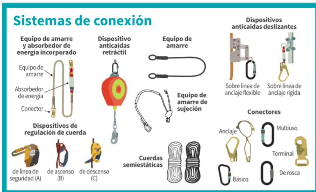
**Dispositivo anticaídas deslizante sobre línea de anclaje flexible:** parte de un sistema anticaídas formado por una línea de anclaje flexible vertical (cable o cuerda que permite movimientos laterales) y un dispositivo anticaídas deslizante con bloqueo automático en caso de caída, que acompaña al usuario en sus movimientos de subida y bajada sin intervención manual. UNE-EN 353.2
