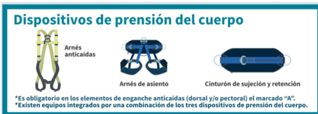
**Arnés Anticaídas:** Dispositivo diseñado ergonómicamente que envuelve el cuerpo de usuario y que tiene por finalidad básica evitar la caída y/o retener al usuario en su puesto de trabajo. Consta de bandas o elementos flexibles de cinta plana de nylon que reparte por la cintura, piernas y hombros los posibles esfuerzos originados durante su uso.
