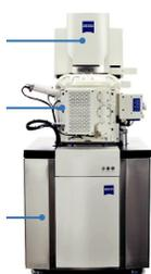
El microscopio de electrones genera una imagen mediante la exploración de un haz de electrones enfocado a través de la muestra.
