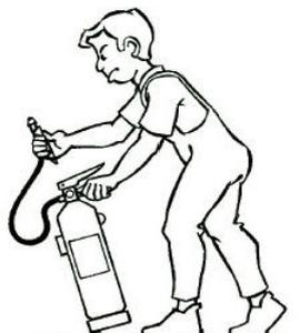
2. Asir la boquilla de la manguera del extintor y comprobar, en caso que exista, que la válvula o disco de seguridad (V) está en posición sin riesgo para el usuario. Sacar el pasador de seguridad tirando de su anilla.
