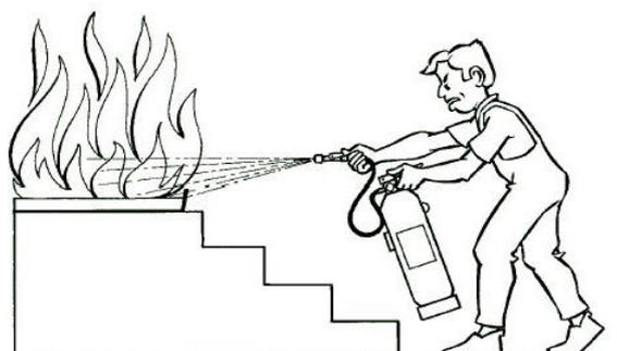
4. Dirigir el chorro a la base de las llamas con movimiento de barrido. En caso de incendio de líquidos proyectar superficialmente el agente extintor efectuando un barrido evitando que la propia presión de impulsión provoque derrame del líquido incendiado. Aproximarse lentamente al fuego hasta un máximo aproximado de un metro.
