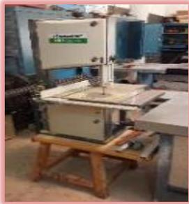
Sierra eléctrica para cortar madera, metal, plástico u otros materiales. Según el material a cortar se utilizan diferentes tipos de hojas.
