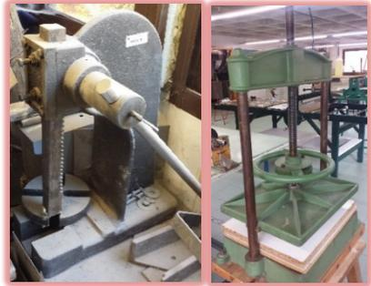
Máquina utilizada para compactar ejerciendo presión a través de un volante de inercia.
