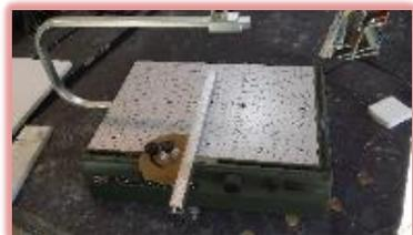
Aparato de corte por alambre caliente para cortar con precisión poliestireno expandido y hojas termoplásticas.
