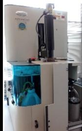
La porosimetría por inyección de mercurio se utiliza para la caracterización del sistema macroporoso de los materiales. Aplicando presión, se fuerza la entrada del mercurio en el entramado poroso del sólido. Se determina el área, el volumen de macro y mesoporos y se calcula la distribución de la porosidad del material.
