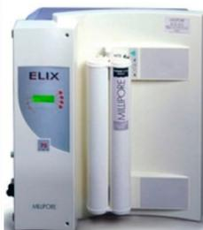
Este equipo produce agua purificada para su uso en laboratorio a partir del agua de la red con diferentes técnicas.
