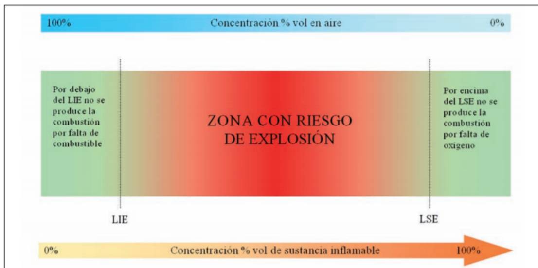
Figura 7 - Rango de explosividad de una sustancia inflamable.
